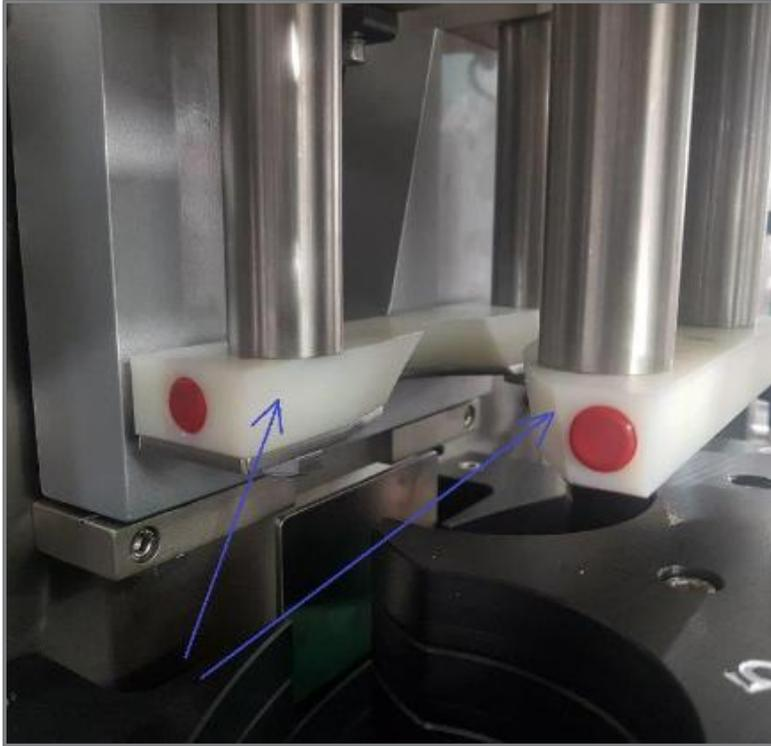
Sostituire i particolari visibili nella foto quando si cambia tipologia di bottiglia.
